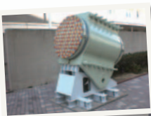
明石海峡大橋 ケーブル&ケーブルパン
