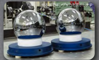
プランク定数の精密測定に使用されたシリコン単結晶球 画像提供: 産業技術総合研究所
