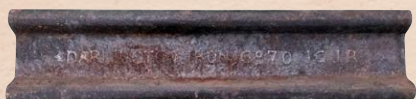
日本の最初期の鉄道に使われたレール (英国 Darlington Iron社製、1870年)
