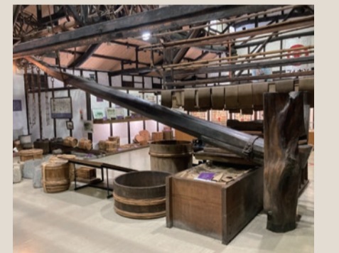
テコの原理でもろみを搾った昔の圧搾機
