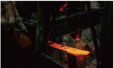
ベルトハンマーで鍛造する様子
