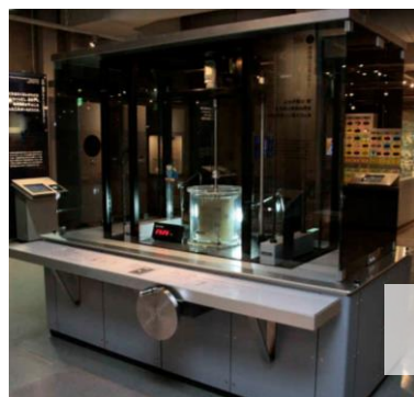
④力から熱へ ジュールの実験
