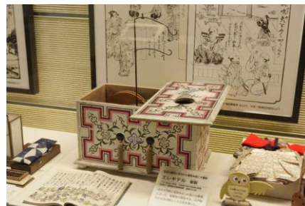
⑦エレキテル 平賀源内製の摩擦起電機 (レプリカ)
