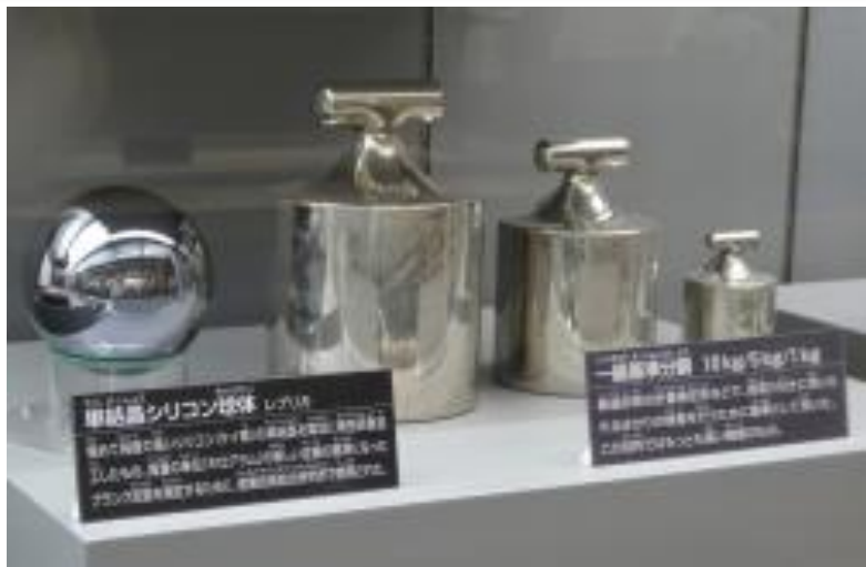
①単結晶シリコン球体 一級基準分銅 10kg/5kg/1kg
