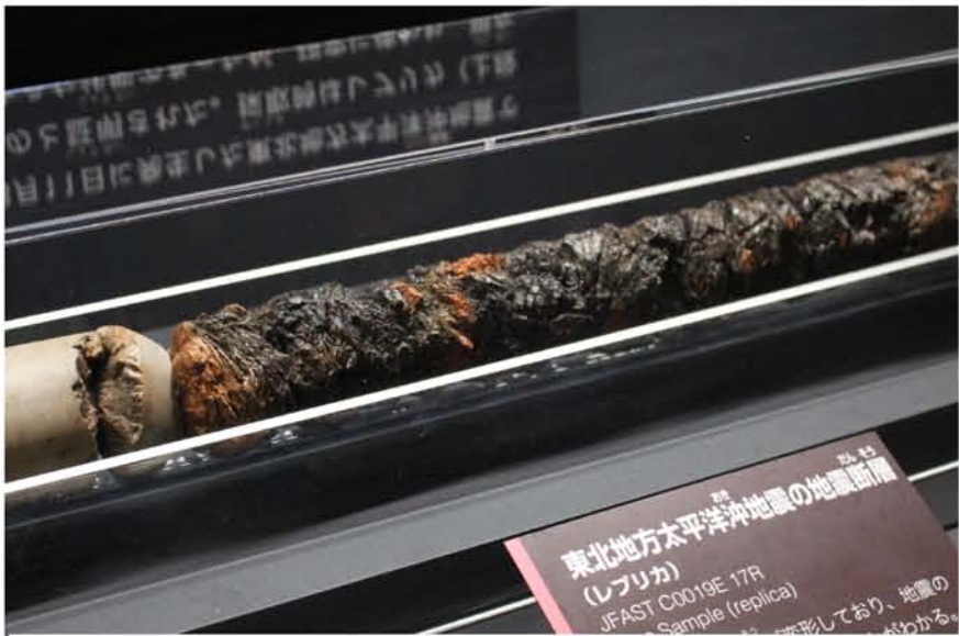
東北地方太平洋沖地震時の地震のすべりによる力を、受けてうろこ状に変形した断層のコア(レプリカ)
