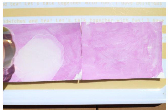
紫外線反応インキを使って：ナスの色の抽出液は、紫外線をカットした。
