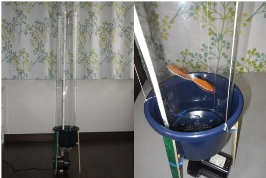
風洞実験装置 電動ポンプの風で上がる高さを測定
