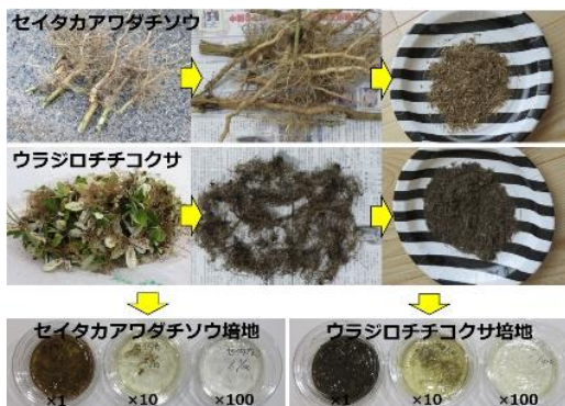
根の採取→乾燥→細断を経て根を含んだ寒天培地を作成
