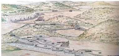
鉄穴流し風景図(砂鉄採取)
