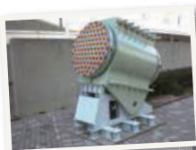
明石海峡大橋 ケーブル&ケーブルバンド
