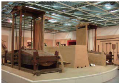
原寸大の製鉄炉と天秤鞆
