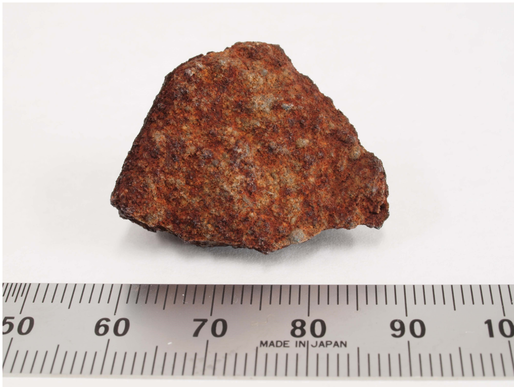
習志野隕石3号（割れた内部、金属粒が錆びて茶色くなっている）
