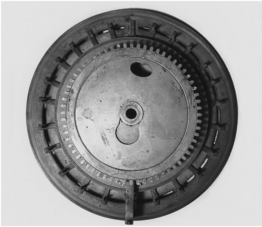
写真5. 文字盤の駆動（日周運動）機構部
