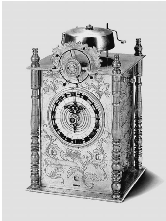
写真19. アンティコルムに掲載の自動割駒式文字盤枕時計機械．アンティコルム代表 Osvaldo PATRIZZI 氏のご好意による．
