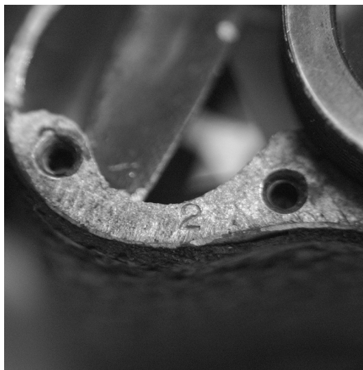
図5-C. 左鏡体対物側の打刻印
