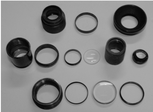
図6. 限度まで分解した接眼側（上・中列）と対物側（下列）の部品
