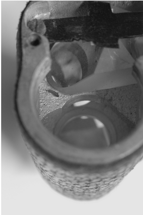
図4. 対物側から見た内部構造 プリズム下左側に位置決めの加締め痕
