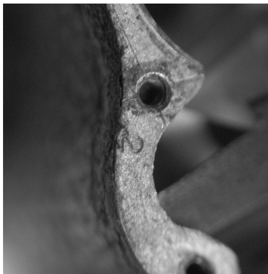
図5-D. 右鏡体対物側の打刻印
