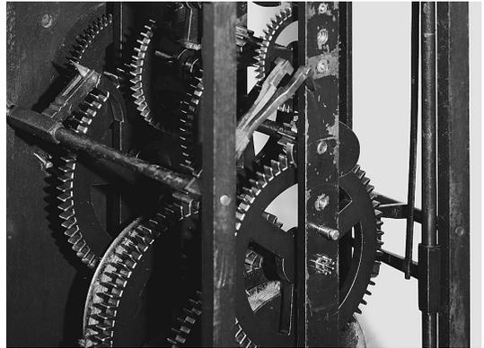
写真7. 時打制御機構 二つ枝金とハート形カム
