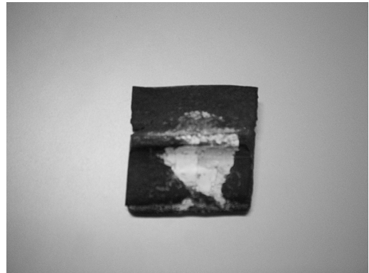
写真2. 『鉄の橋』（コールブルックデール）で使用した素材と同等の練鉄。エイブラハム・ダービー卿の高炉模型で製造された鉄塊を鍛錬によりスラグ成分を絞り出して作成した練鉄。溶製や加工履歴を反映してインクルージョンを含み、方向性のある複合材料としての特性が付与され、構造要素として活用された
