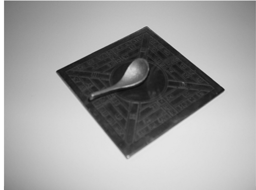
写真1. 古代中国の方位磁石。中国鉄鋼研究所が、現代の冶金的な知見を基に古代の原料の純度、製造法等を推測し、再現したレプリカ
