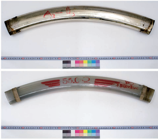
図6 真空容器の外観 上：銀コーティング，下：NESAコーティング
