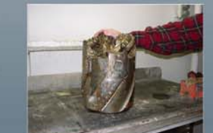
掘削船調査で使用したドリル 岩石の掘削中に一部破損
