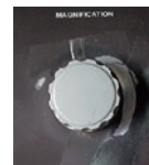
電子顕微鏡の倍率のつまみ (25年間使用:鉄板のすり減り)
