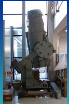
国立天文台堂平観測所で 使われていた彗星写真儀 (シュミットカメラ)
