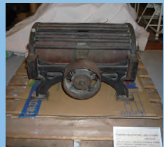
▲ 3: Thomson Houston Arc Light Dynamo トムソン・ヒューストン・エレクトリック社製、アーク灯用交流発電機。1,200燭光、30燈用。大阪電燈株式会社の最初の火力発電所、西道頓堀発電所で創業の1889年に使用されていた。アーク灯とは、放電が発する強い光を利用した明かりで、明治時代に主に街灯や工場照明などに用いられた。
