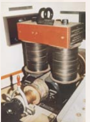
日本で最初の事業用発電機で使用された発電機 エジソンダイナモ
