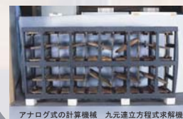
アナログ式の計算機機 九元連立方程式求解機
