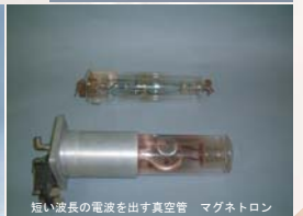
短い波長の電波を出す真空管 マグネトロン
