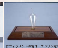
竹フィラメントの電球 エジソン電球
