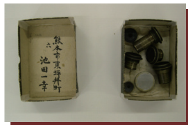
接眼鏡が紙箱に保存されている： 最短の焦点距離は1/8インチ (最高倍率236倍)
