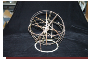
渾天儀「三極通儀」全体 金属製、球径約27cm
