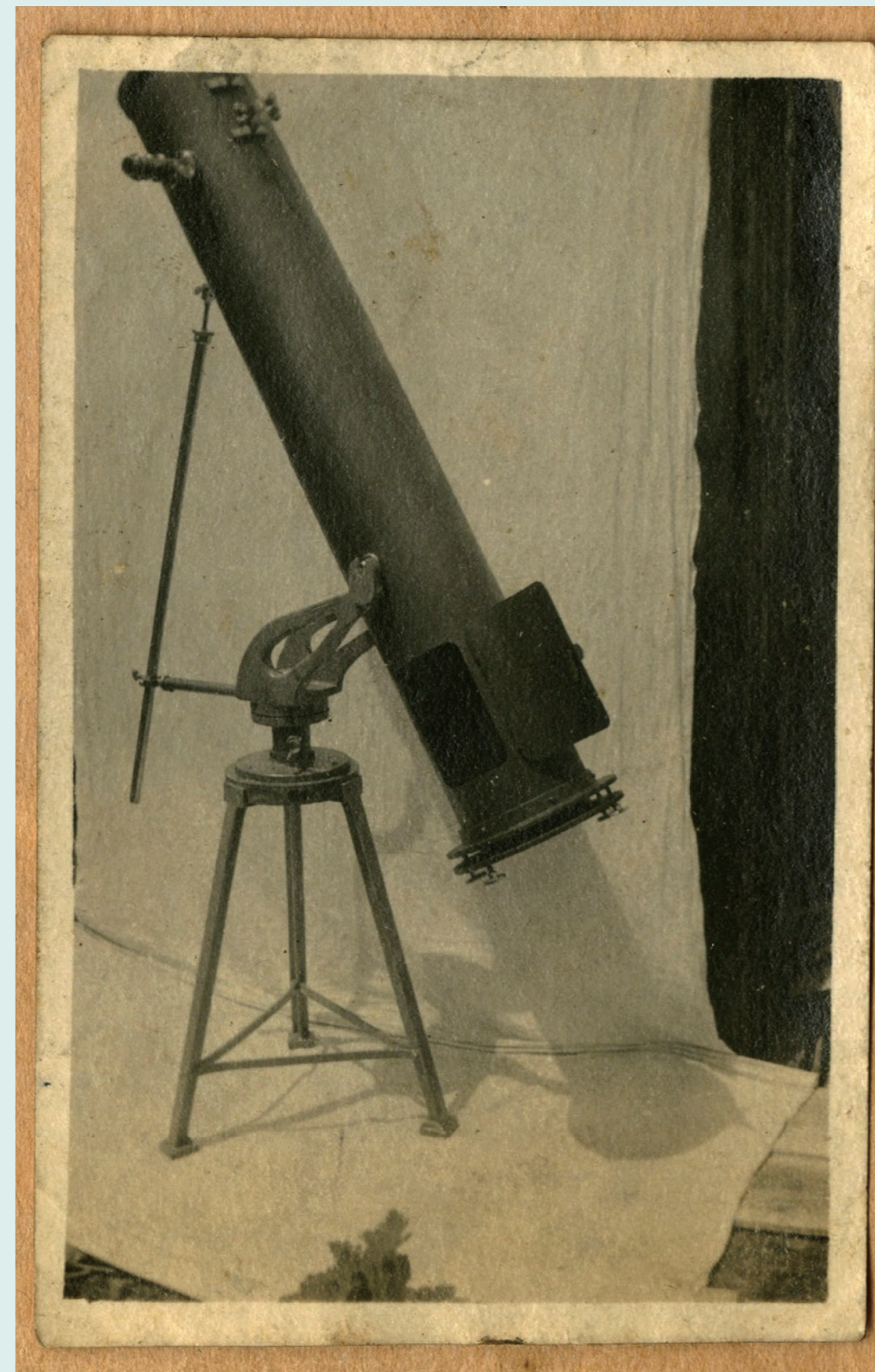
国産初の口径 15 cm 反射望遠鏡です。鏡は京都大学の中村要 (なかむら かなめ 1904-32) が製作しました。架台は西村製作所製。残念ながら現物は残っていません。
