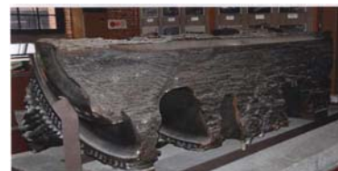
破壊したロータ破片
