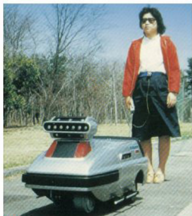
図1 盲導犬ロボット「MELDOG MARKIV」 操作者の行動範囲の地図情報を登録しておき、そこに書き込まれたランドマークを指標に、操作者を誘導する。盲導犬特有の「賢い不服従（指示が出ていても、危険を察知したらその指示には従わない）」という機能も再現された。
