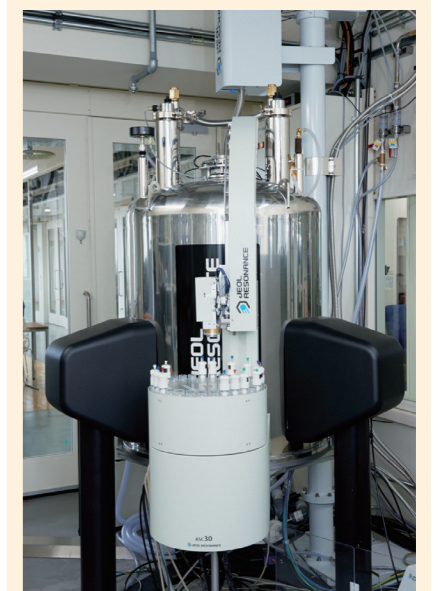
図1 現在の相田先生の研究室に備えられているNMR(核磁気共鳴装置) 中央下に見えるタンクの中心に試料をセットし磁場をかけることで、有機物の平面構造や立体構造を知ることができる。
