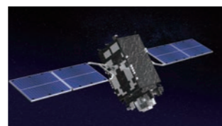
日本国の測位衛星である準天頂衛星「みちびき」のCG画像。4機の測位衛星からの電波信号を受信することで緯度、経度、高さを割り出すことができます。画像提供：内閣府宇宙開発戦略推進事務局
