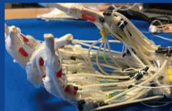
空気圧でしなやかな動きを再現する人工筋肉。 画像提供: 鈴森康一
