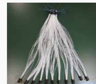
空気で収縮する人工筋肉。 画像提供: 鈴森康一
