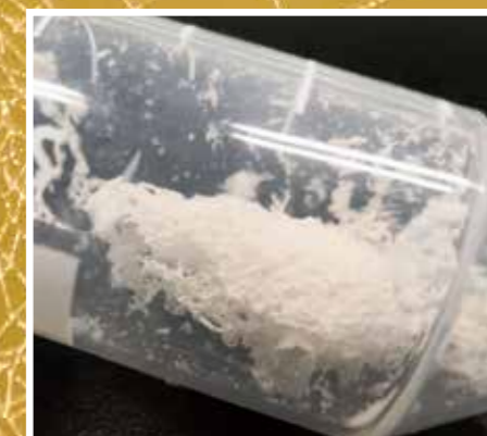
▲クモ糸シルクタンパク質を合成する海洋性紅色光合成細菌の大量培養装置 (上) と細菌から抽出・精製されたタンパク質 (下)。これを繊維化して化学繊維に代わる次世代繊維を実現させることに成功。 画像提供: 京都大学 理化学研究所
